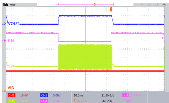
图 36.EN 引脚开关机波形 ( V_{IN}=24V , V_{OUT}=5.0V , I_{OUT}=0.5A )
