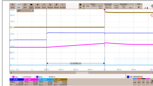
图 8-4. 85Vac 和空载条件下的启动波形
