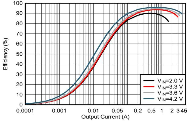
$V_{IN} = 2.0V, 3.3V, 3.6V, 4.2V$ ;  $L = 0.47 \mu H$ , PWM 模式
