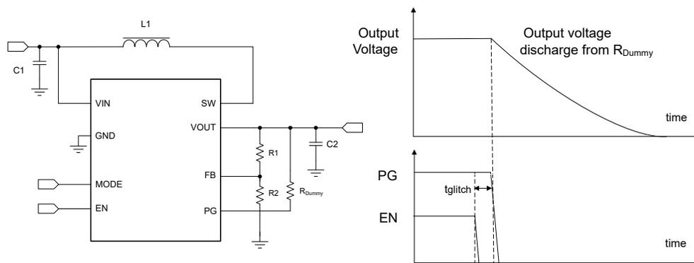
图 7-1. 通过 PG 功能实现输出放电
