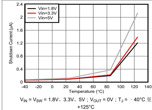
图 6-9. 关断电流与温度间的关系
