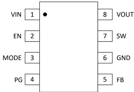
图 5-1. DRL 封装 8 引脚 SOT583 顶视图
