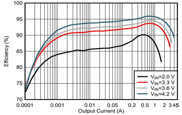
$V_{IN} = 2.0V, 3.3V, 3.6V, 4.2V$ ;  $L = 0.47 \mu H$ , 自动 PFM 模式
