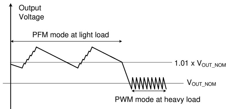
图 7-2. PWM 模式和 PFM 模式下的输出电压
