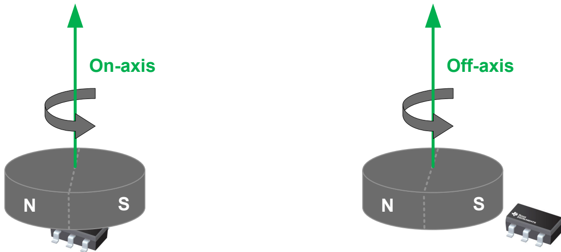
图 7-16. 同轴角度测量与离轴角度测量
