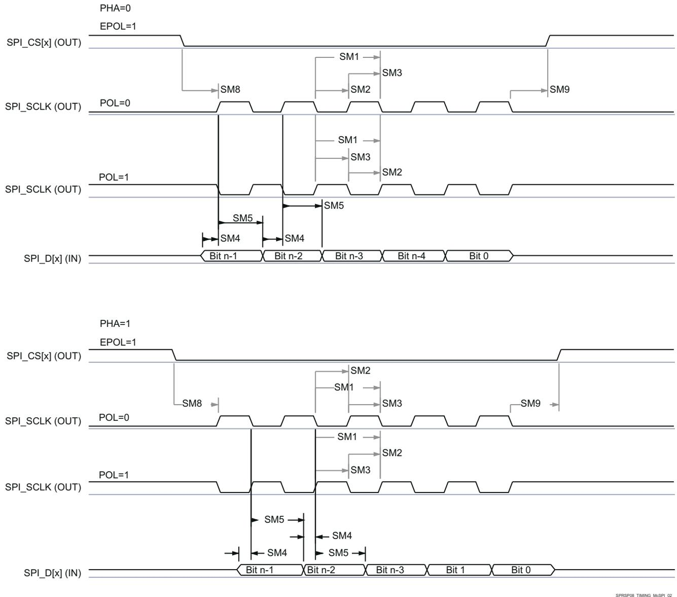
图 7-11. SPI 时序 — 控制器模式接收
