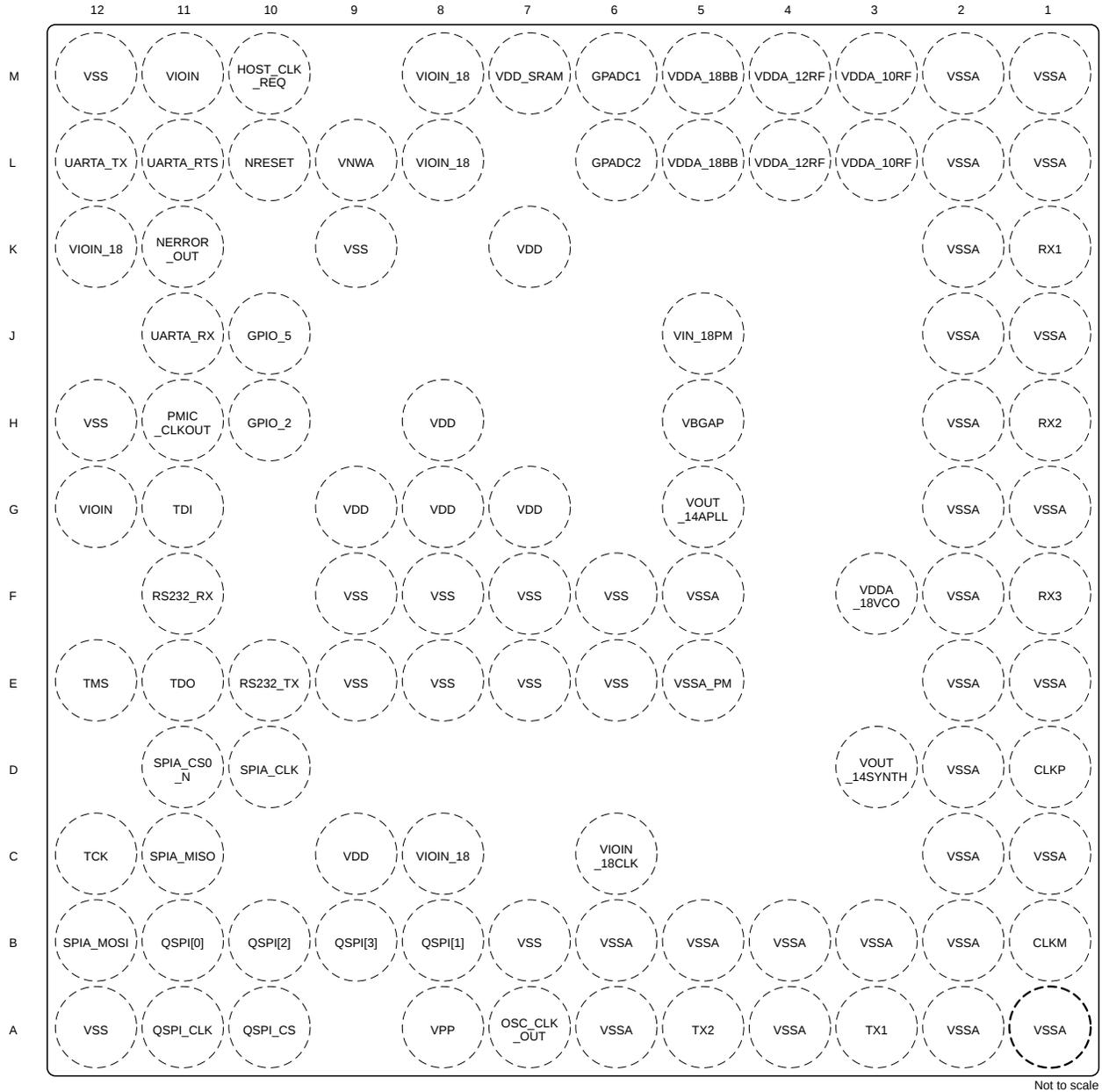
图 6-1. AFCCSP 引脚图 (顶视图)
