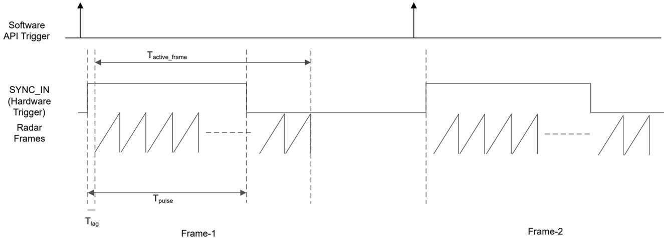
图 7-9. SYNC IN 硬件触发器
